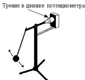
Рис.3. Сухое трение в датчике угла поворота (потенциометре)
