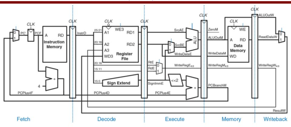
Конвейерный тракт данных можно получить, порезав однотактный тракт данных на пять стадий, разделенных регистрами (pipeline registers).
