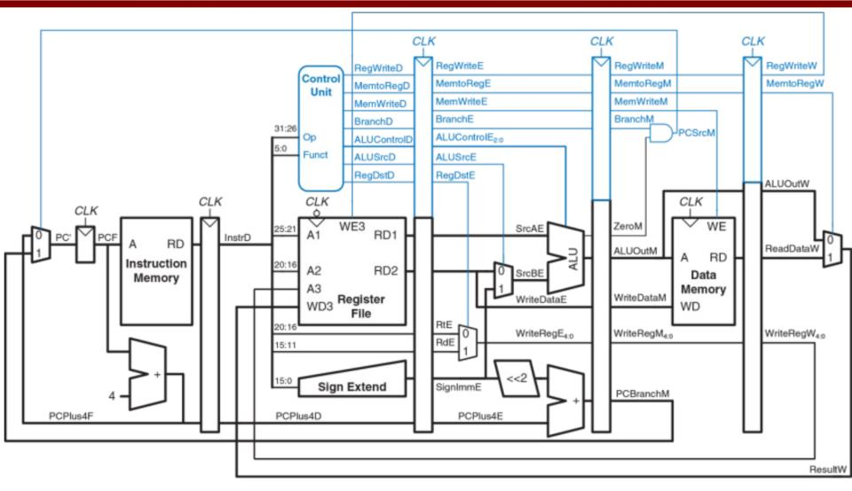
Конвейерный процессор использует те же управляющие сигналы, что и однотактный процессор, поэтому использует такое же устройство управления. Эти сигналы конвейеризуются точно так же, как и тракт данных, чтобы оставаться синхронными с командой, перемещающейся из одной стадии в другую.
