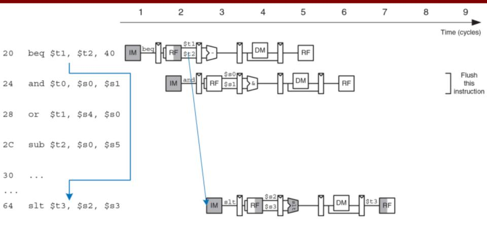
Функционирование конвейера с ранним вычислением условий перехода, происходящим на втором такте.
